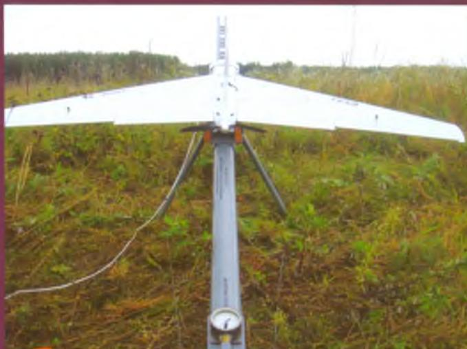
Видеосъемка возможна как постоянная, в течение всего полета, так и над заданными участками маршрута – по команде оператора. При желании на БПЛА вместо видеокамеры монтируется ИК-камера, позволяющая фиксировать очаги теплового излучения (возгорания). Высота полета БПЛА не более 50 метров, что позволяет получать фото- и видеодокументацию отличного качества, ее можно будет использовать при формировании доказательной базы в ходе расследования.
