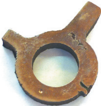
На фото: Срез звена ТДТ-55 китайского производства с явными литейными раковинами.
