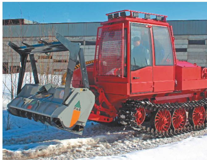
ООО «Онежский тракторный завод» (входит в состав машиностроительно-индустриальной группы «Концерн «Тракторные заводы») завершил полевые испытания новой модели гусеничной машины «Онежец-390» для срезания и измельчения кустарника и веток, древесных стволов диаметром до 25 сантиметров.
